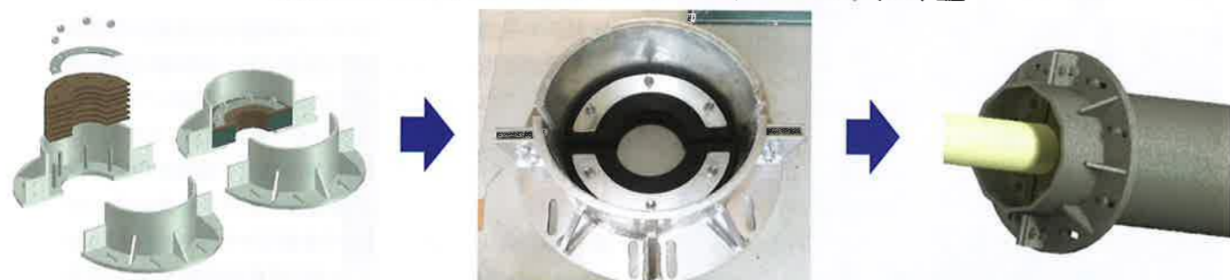
エチオピア アベイ橋 プレキャスト型リングダンパー 構造イメージと設置イメージ
