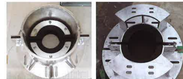
写真-6 アベイ橋リングダンパー
