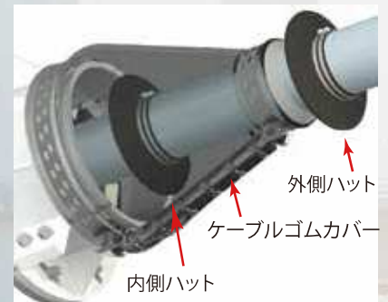
ハットをゴムカバー内側と先端外側に併用しているイメージ
