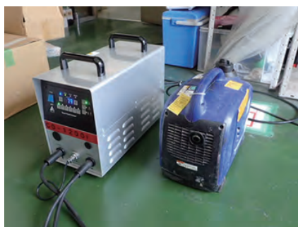
写真-4 左) MWTスタッドボルト本体 右) ポータブル発電機100V
